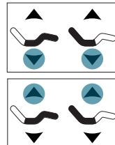
CABEZA ABAJO + PIE ABAJO -Mantener presionado por 3 segundos y enseguida Cabeza Arriba + Pie Arriba - Mantener 3 segundos hasta que la luz parpadee.
